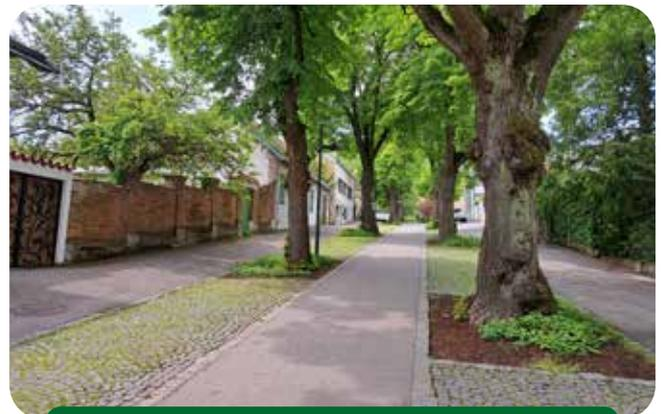
Versickerungsfähige Bodenbeläge unterstützen die kühlende und schattierende Vegetation.
